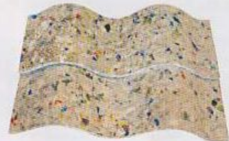
Tijolo feito de eucalipto e revestido com fibras de bananeira
